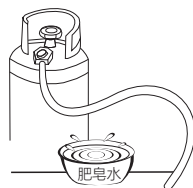
管道气密性检测
