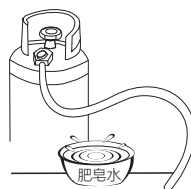
管道气密性检测
